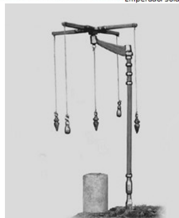
Groma: Instrumento topográfico para situar el Cardus (N-S) y el Decamanus (E-O)
